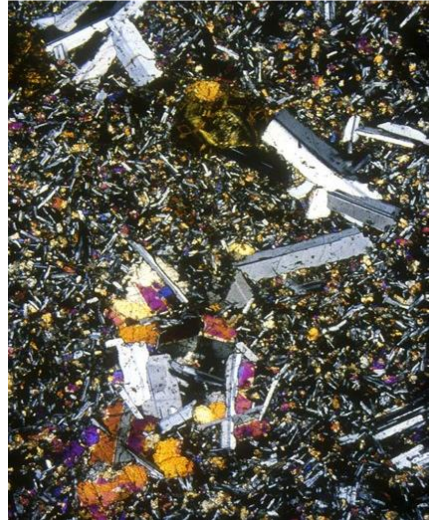
Microphotographie d'une lame mince de basalte en LPA
